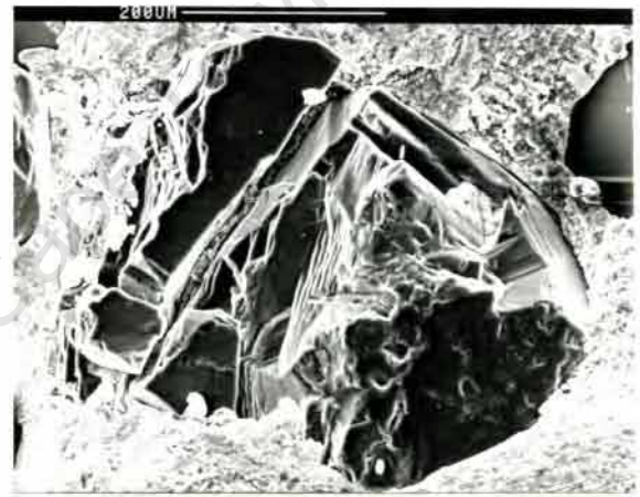
(d) : Type 2b - cleavage and microfracture : Quartz
