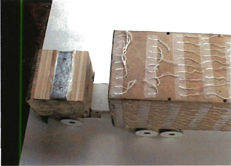
a: flow separation on the top edge
